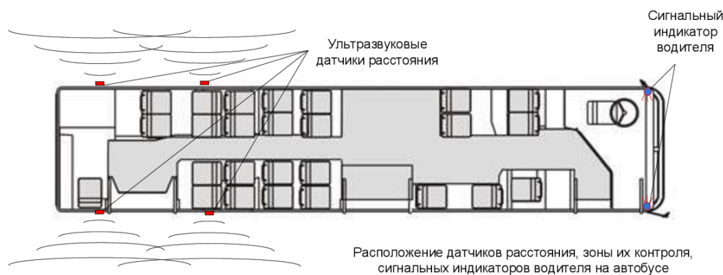
Рисунок 2.15 – Расположение на автотранспорте датчиков расстояния, область их наблюдения и предупреждающих индикаторов водителя
