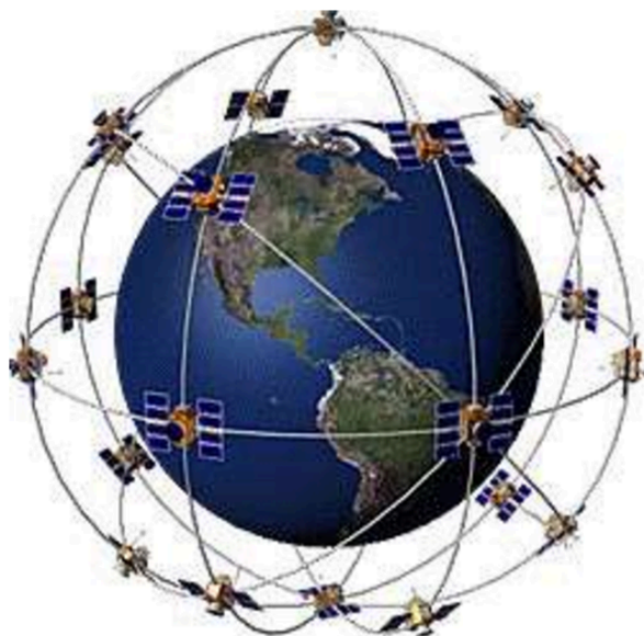
Рисунок 1.1 – График расположения спутников GPS вокруг Земли
