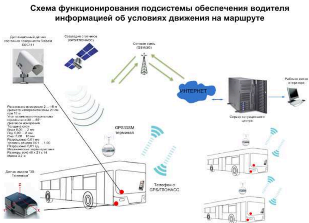
Рисунок 2.18 – Схема работы подсистемы обеспечивающей водителя своевременными данными о состоянии движения на маршруте
