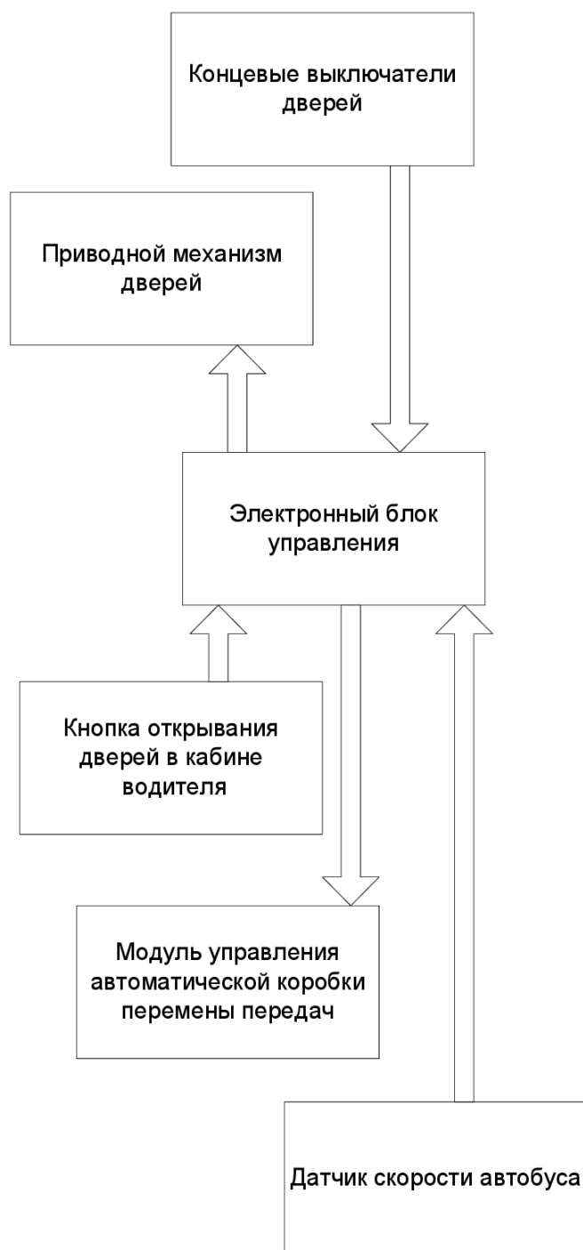
Рисунок 2.12 – Структурная схема прибора, не дающего произвести начало движения автотранспорта при открытых дверях и открывания дверей при неполной остановке
