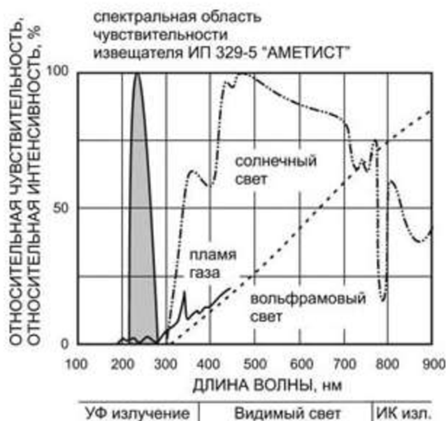
Рисунок 2.4 – Спектральная зона реагирования извещателя
