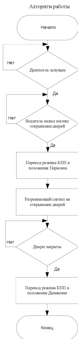
Рисунок 2.13 – Блок-схема функционирования прибора предотвращения начала движения автотранспорта при открытых дверях и открывания дверей при неполной остановке автобуса
