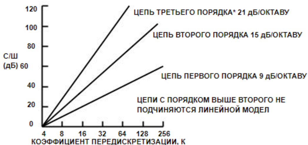
Рисунок 14 – Соотношение сигнал-шум и коэффициент передискретизации для циклов первого, второго и третьего порядка
