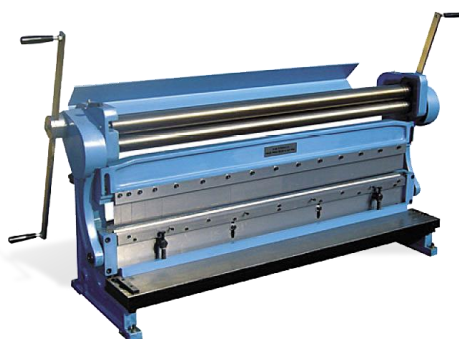
Рисунок 2.9 - Станок универсальный GBR 1315 (листогиб, вальцы, гильотина)
