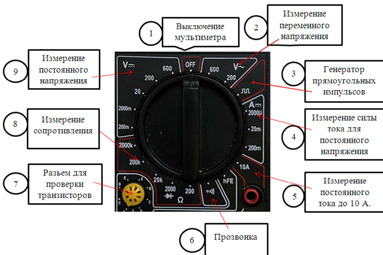
Рис. 6. Основные обозначения мультиметра М832
