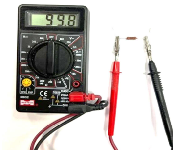
Рис. 33. Измерение мультиметром сопротивления резистора № 2
