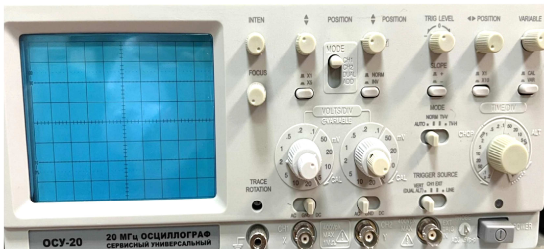
Рис. 12. Осциллограф сервисный универсальный ОСУ-20
