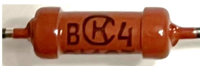
Рис. 18. Маркировка завода производителя резистора № 1
