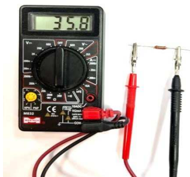
Рис. 32. Измерение мультиметром M832 сопротивления резистора № 1
