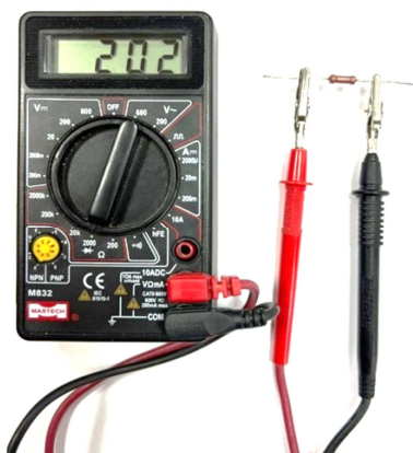
Рис. 34. Измерение мультиметром сопротивления резистора № 3 Резистор №4. Номинальное значение сопротивления по маркировке 270 Ом.
