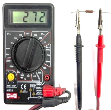
Рис. 35. Измерение мультиметром сопротивления резистора № 4
