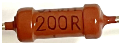
Рис. 24. Номинальное сопротивление резистора № 3 I· – допускаемое отклонение сопротивления резистора. Отклонение от номинального значения \pm 5 \%
