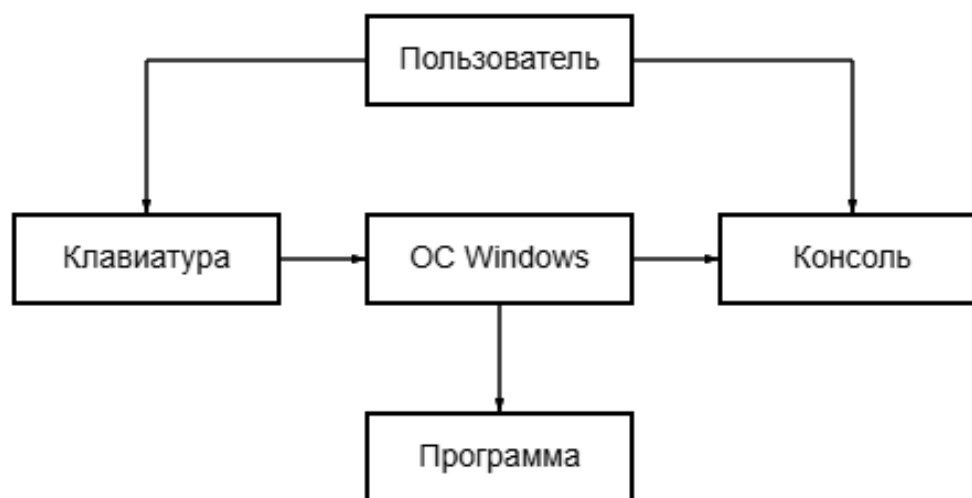
Рисунок 2 — Схема взаимодействия пользователя, программы и операционной системы
