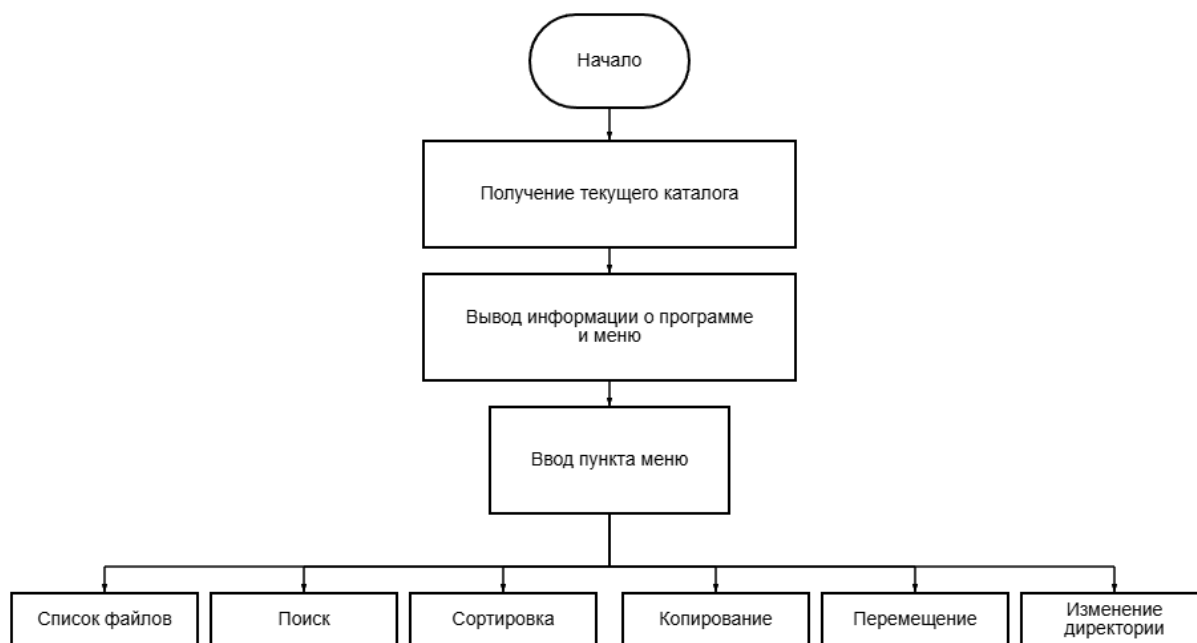
Рисунок 3 — Блок-схема работы главного цикла программы
