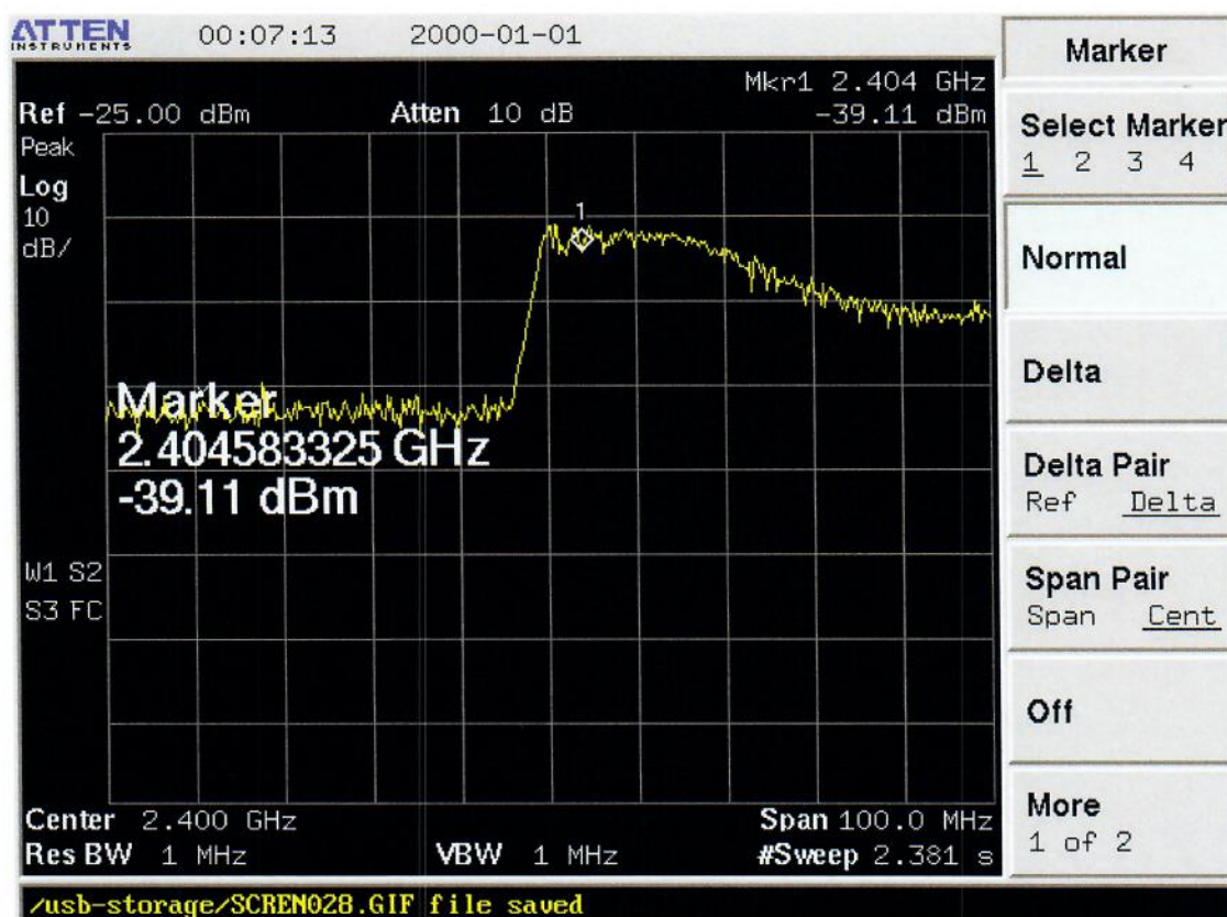
Рисунок 73 — Влияние помех на принимаемый сигнал в частотном диапазоне 2,4 ГГц
