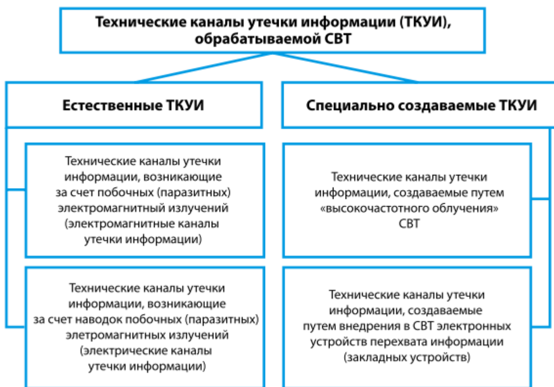
Рисунок 1.13 – Классификация технических каналов утечки информации, обрабатываемой средствами вычислительной техники (СВТ)
