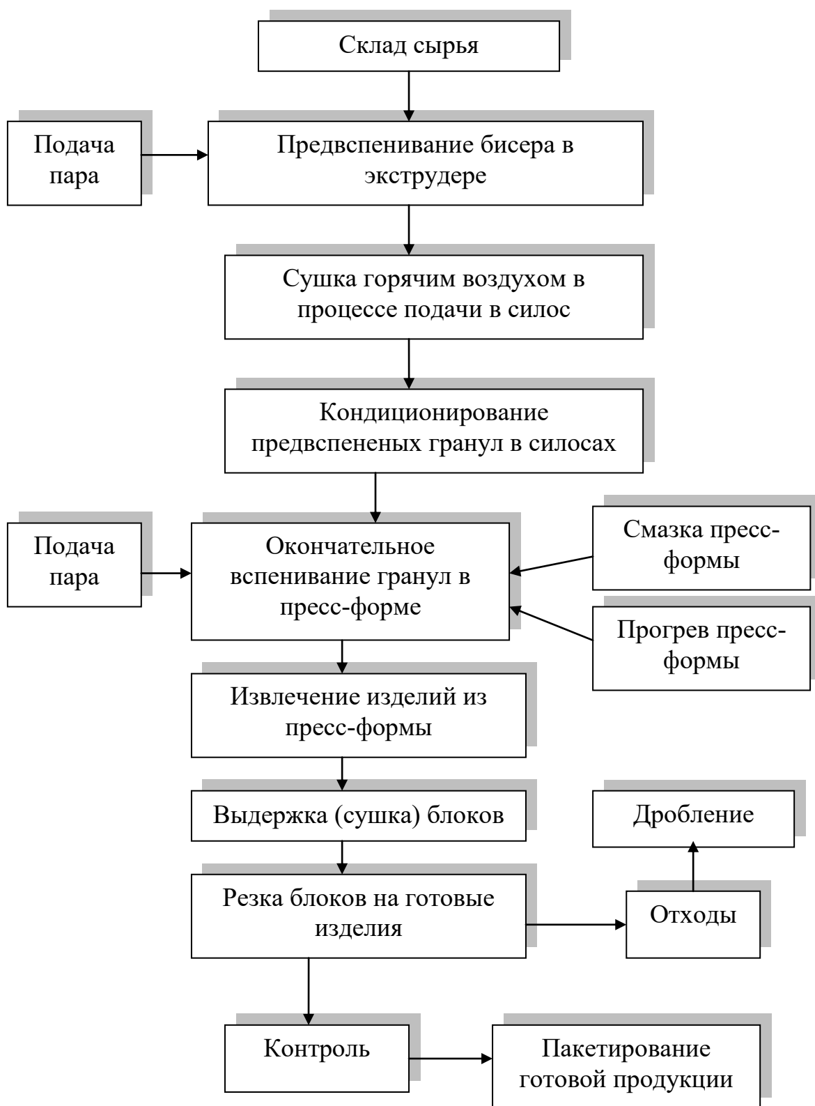
Рисунок 2.3 - Технологический процесс производства декоративных элементов из пенополистирола
