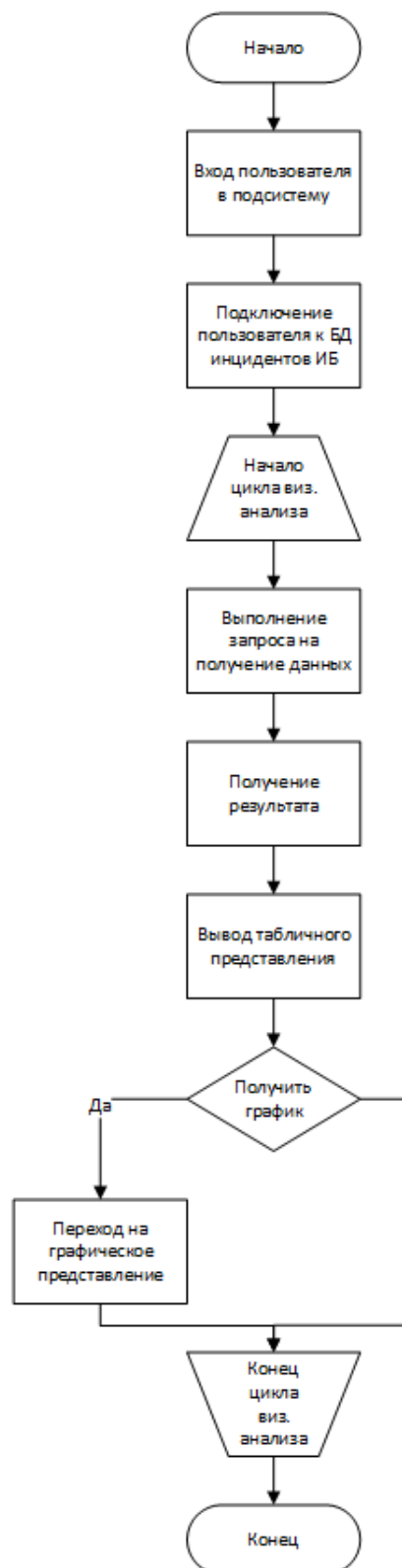
Рисунок Б.1 – Алгоритм работы программного обеспечения подсистемы визуального анализа
