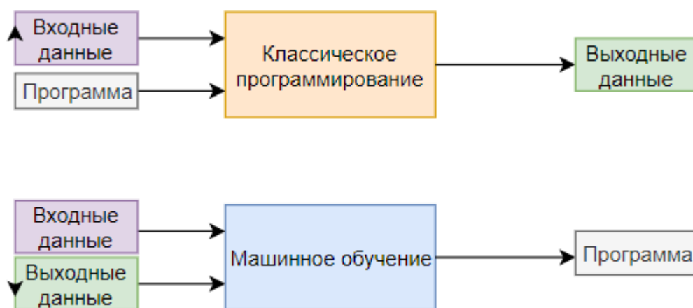
Рисунок 2 – Отличие классического программирования от ML
