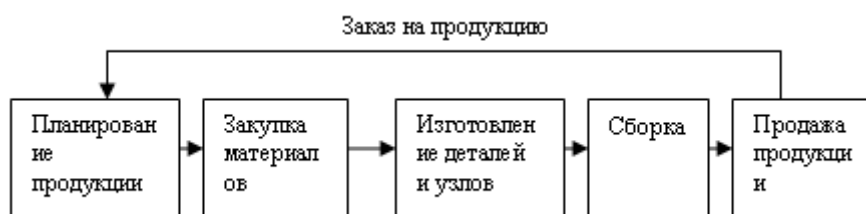
Рисунок 3.1 - Схема традиционной организации производства
