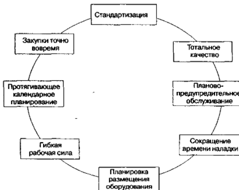
Рисунок 3.3 - Последовательность внедрения принципов Just-in-time в ИП Дяркин Р.А.
