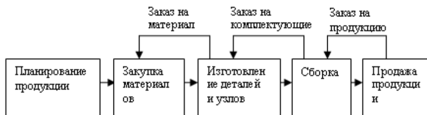
Рисунок 3.2 - Схема организации производства по схеме «Точно вовремя»
