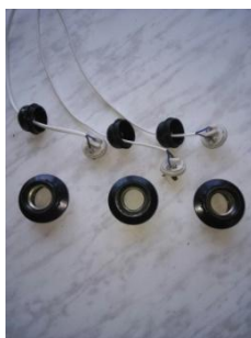
Рис. 8. Соединение проводов с патронами
