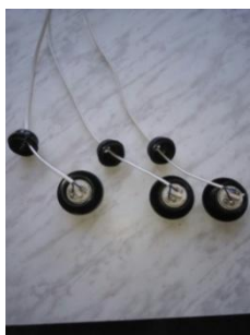
Рис. 9. Соединение проводов с патронами
