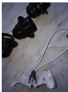
Рис. 10. Соединение проводов с вилкой
