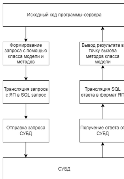
Рисунок 2 – Схема запроса к БД через Django ORM
