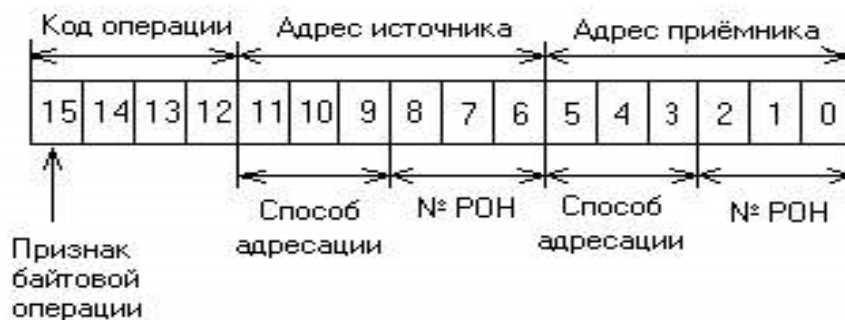
Рисунок 2 - Формат двухадресных команд
