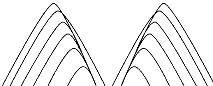
Рисунок – 8. Формообразование резбовой поверхности при снижении подачи на глубину, но с формообразованием одной из сторон профиля по генераторной схеме
