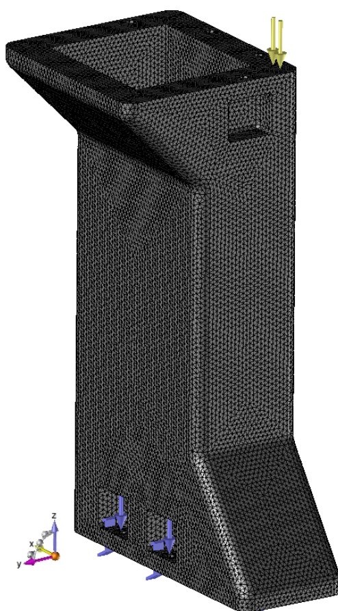
Рисунок 53 – Нанесение сетки на твердотельную модель
