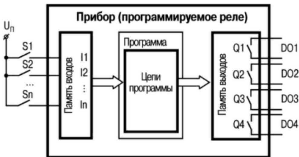
Рисунок 1 – Функциональная схема выполнения программы ПЛК
