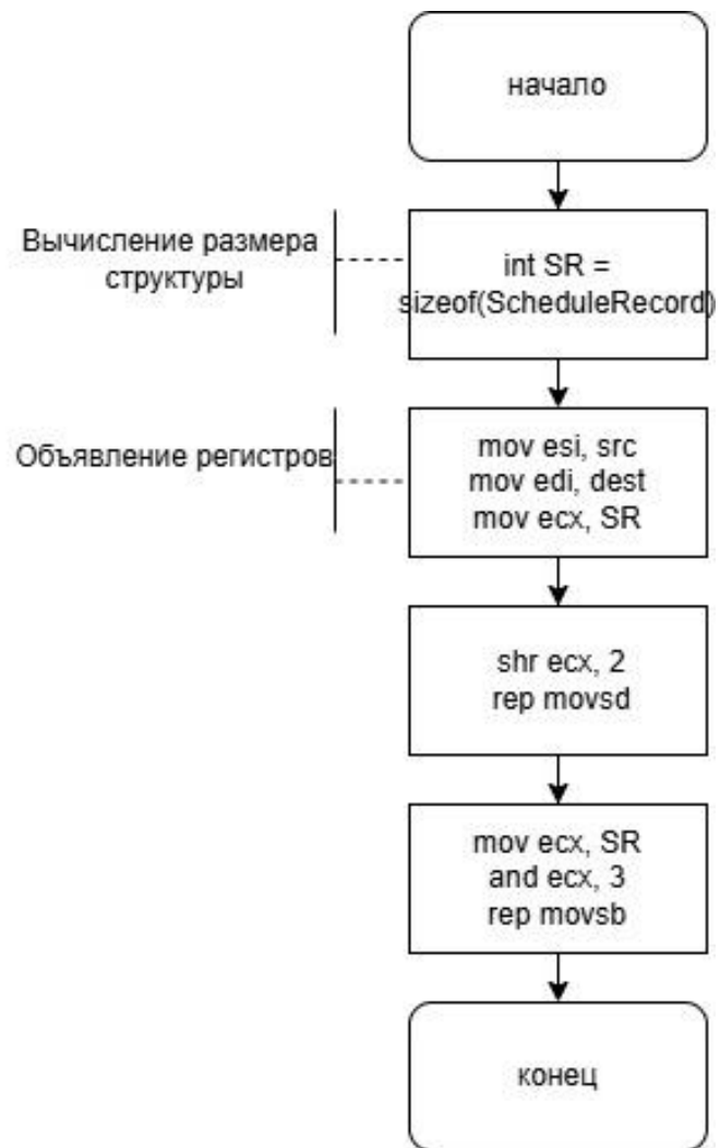
Рисунок 8. - Схема программы. Функция fast_copy
