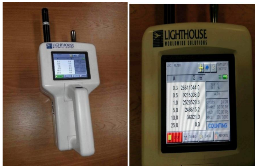
Рисунок 3.6 - Ручной лазерный счетчик частиц Lighthouse HANDHELD 3016
