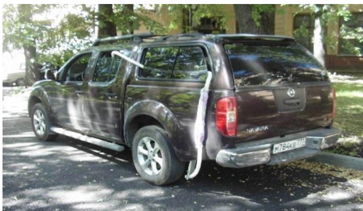
Рисунок 3.3 - Установка измерительного трубопровода на автомобиле.
