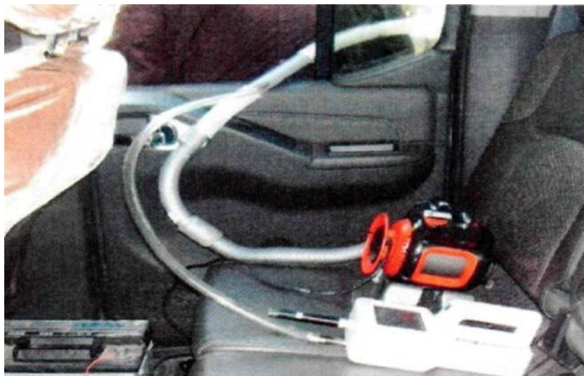
Рисунок 3.4 - Установка измерительного комплекса в салоне автомобиля.
