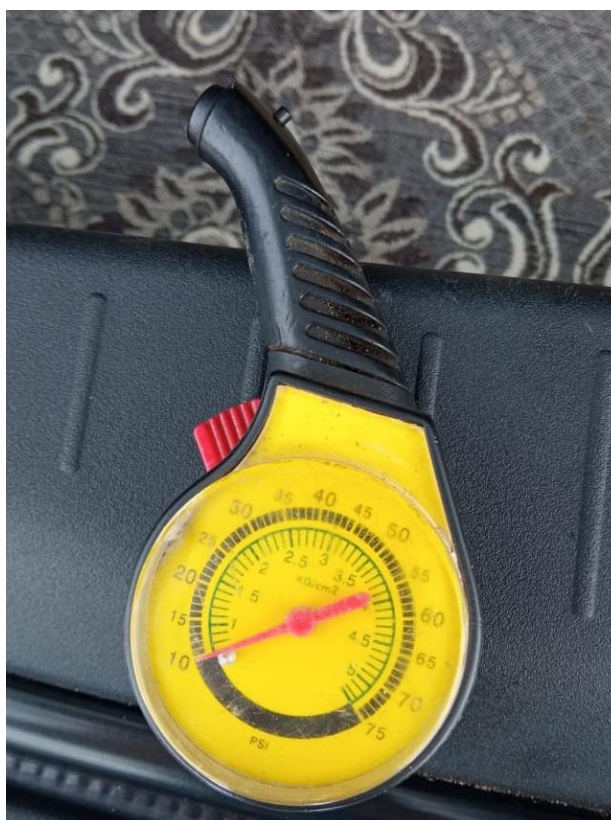
Рис. 16. Внешний вид стрелочного манометра
