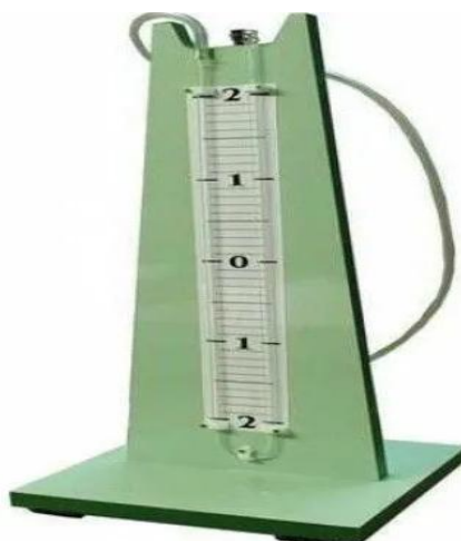
Рис. 11. Внешний вид жидкостного манометра
