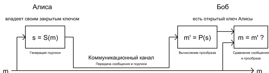
Рисунок 11 – Алгоритм формирования и проверки цифровой подписи RSA.
