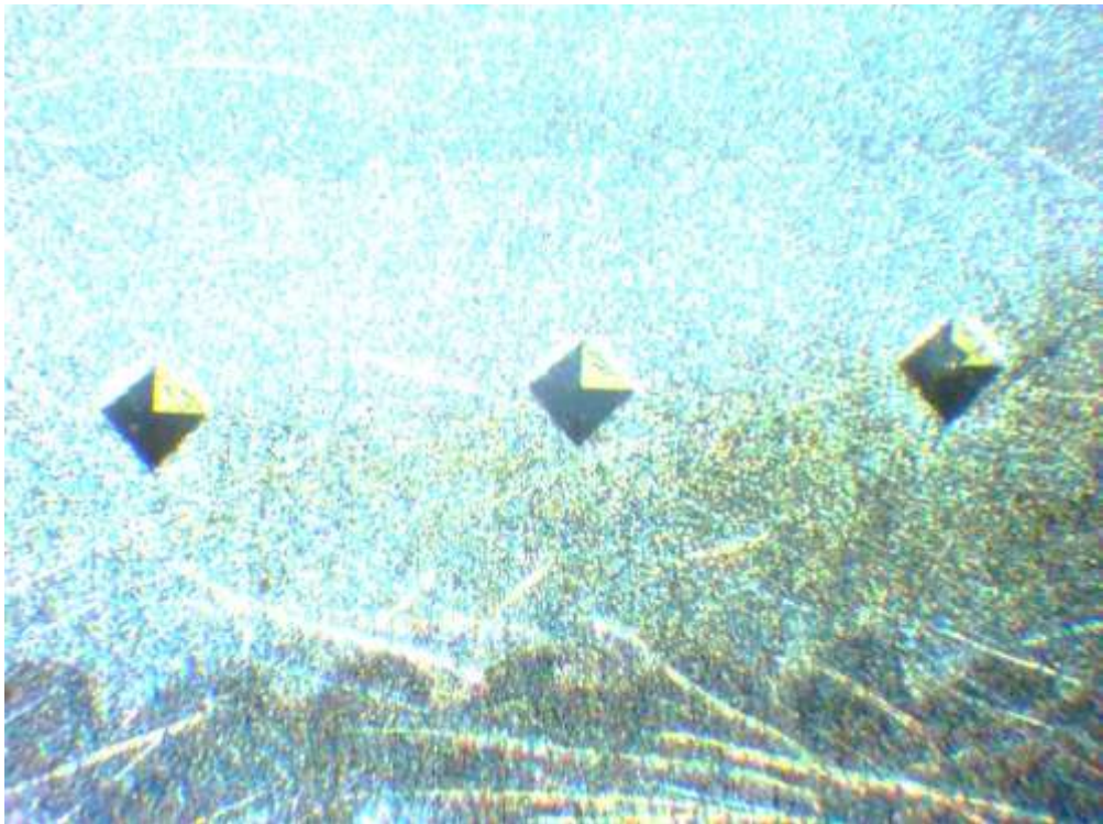
Рисунок 13 – Схема замера твердости
