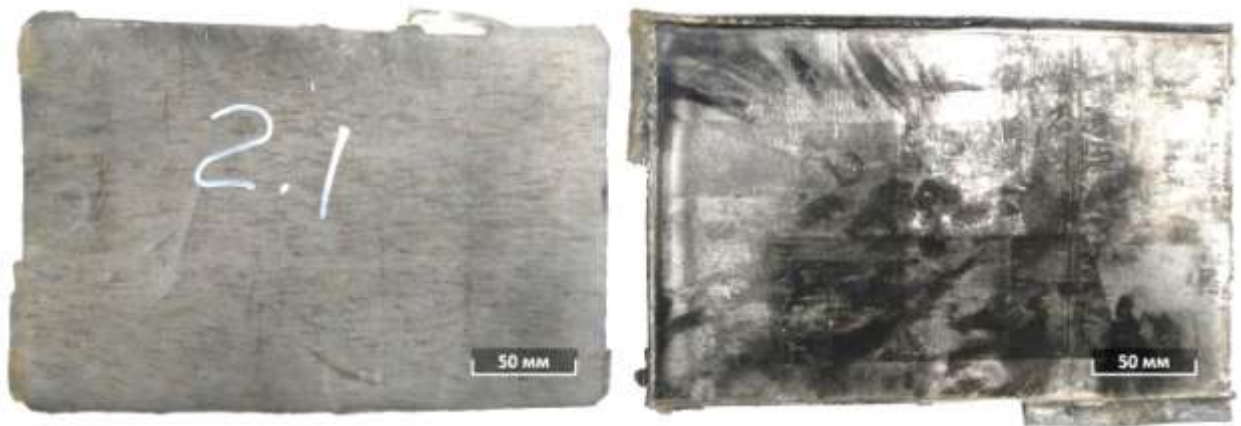
Рисунок 10 – Заготовка после сварки взрывом (лицевая и оборотная стороны)
