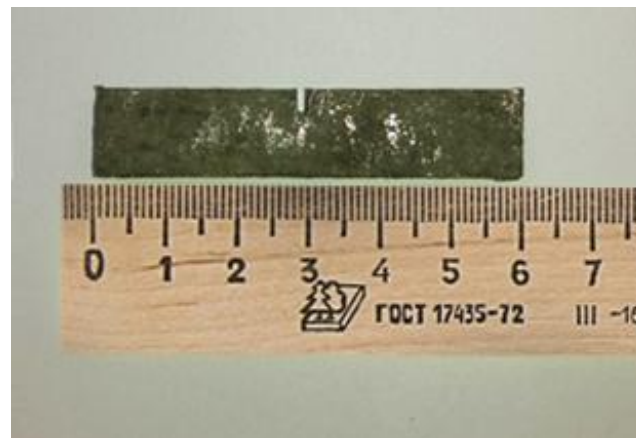
Рисунок 10 – Образцы для испытания на ударную вязкость:
