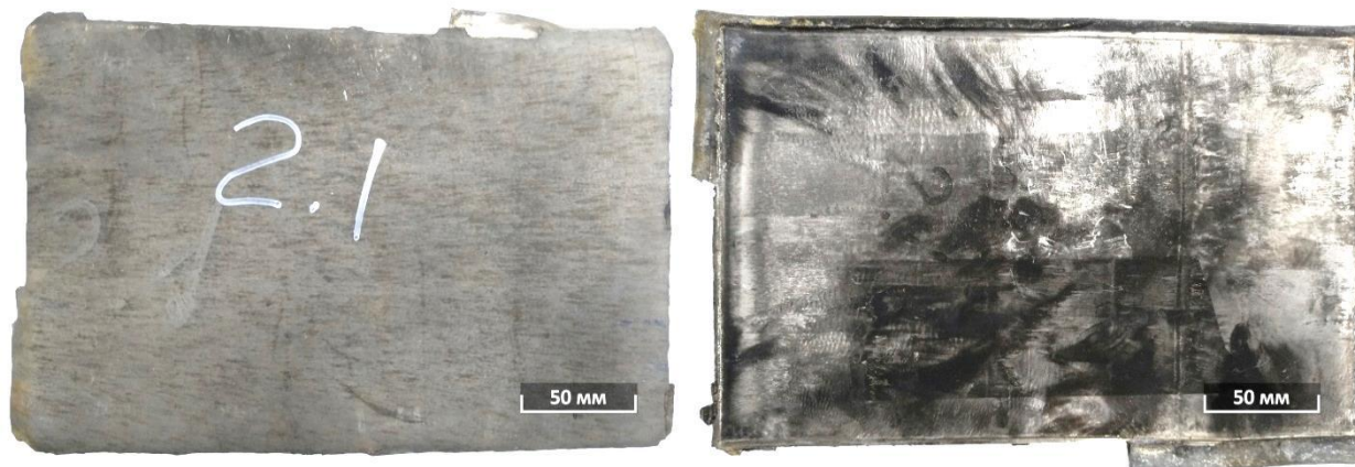
Рисунок 12 – Заготовка после сварки взрывом (лицевая и оборотная стороны)
