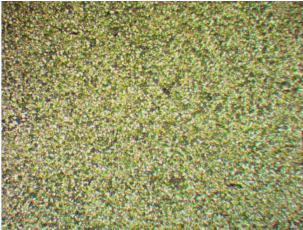
Рисунок 25 – Микроструктура стали 65X13 (режущий слой) после закалки и среднего отпуска
