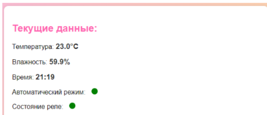
Рисунок 33 – Результат работы логики срабатывания при значении датчика менее 60% или температуры больше 25 градусов
