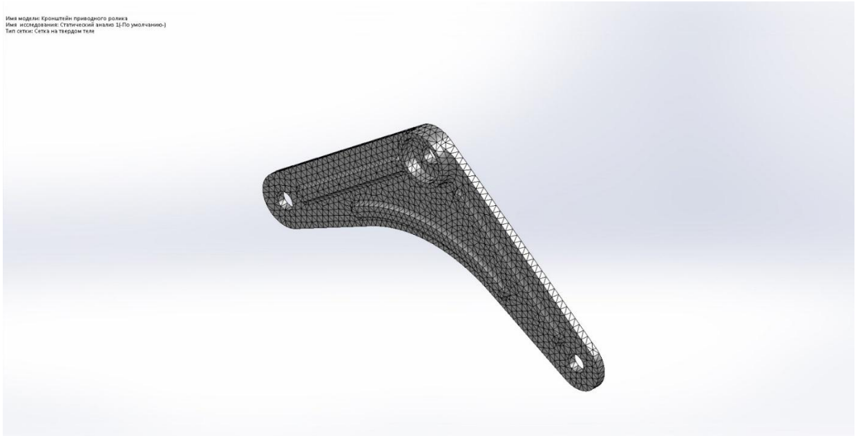
Рисунок 2.11 – Наложенная на деталь сетка
