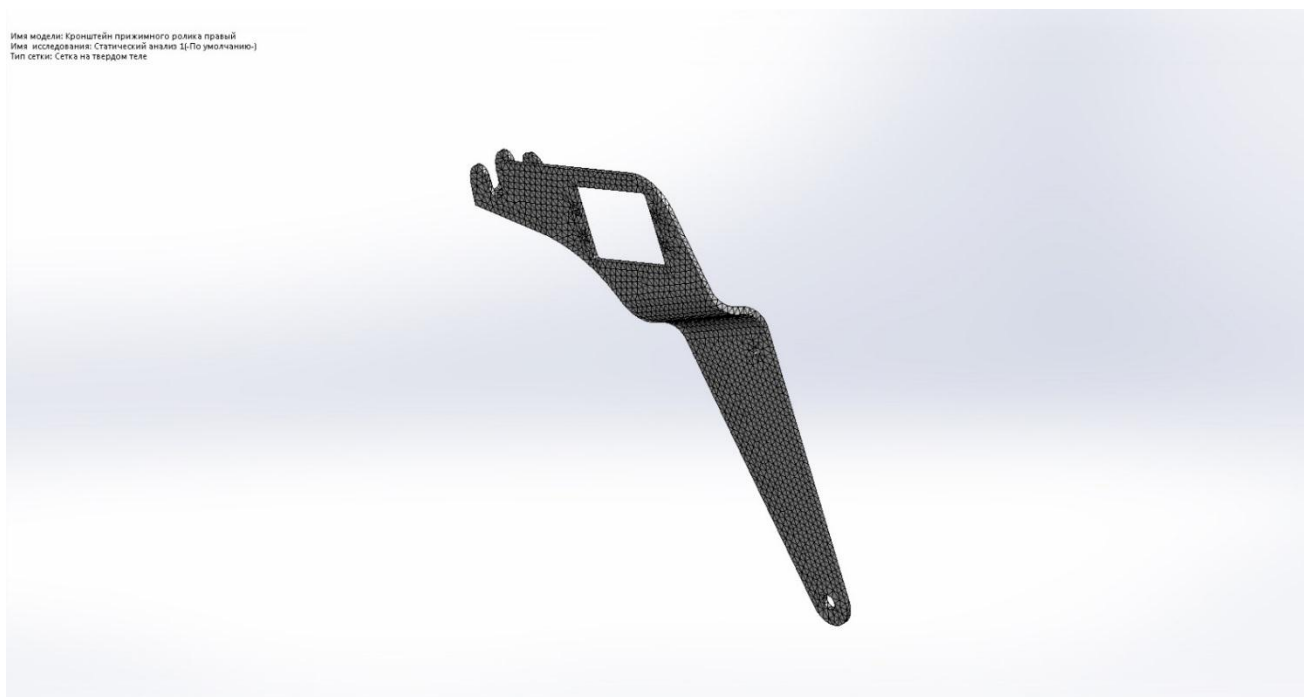
Рисунок 2.16 – Наложённая на деталь сетка
