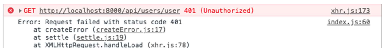
Рисунок В.5 – Некорректный токен доступа
