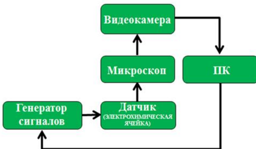
Рисунок 3.13 – Структурная схема созданного устройства для анализа ЭКЗОСОМ
