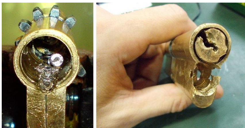
Рисунок 6 – Высверливание штифтов механизма секрета
