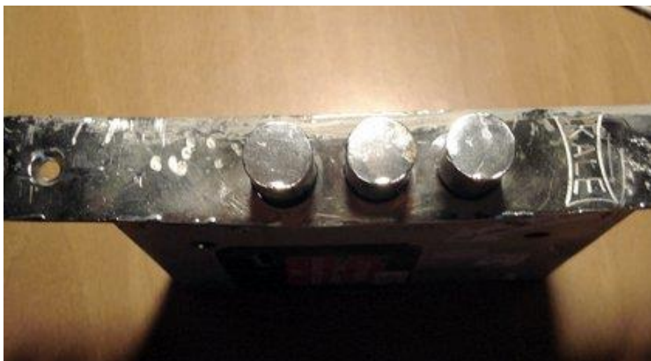
Рисунок 5 – Следы от забивания ригелей
