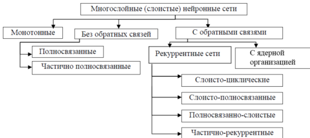
Рисунок 27 – классификация многослойных нейронных сетей
