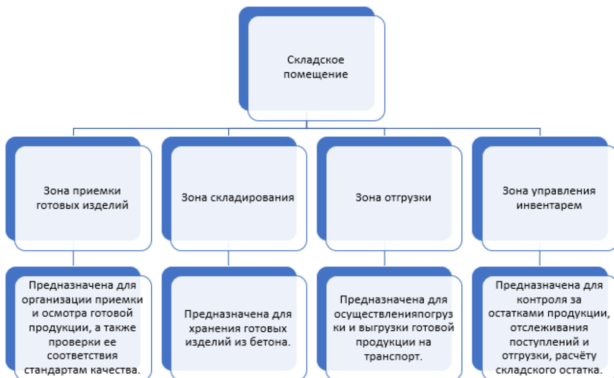
Рисунок 2.3 – Зонирование складского помещения предприятия по изготовлению изделий из бетона
