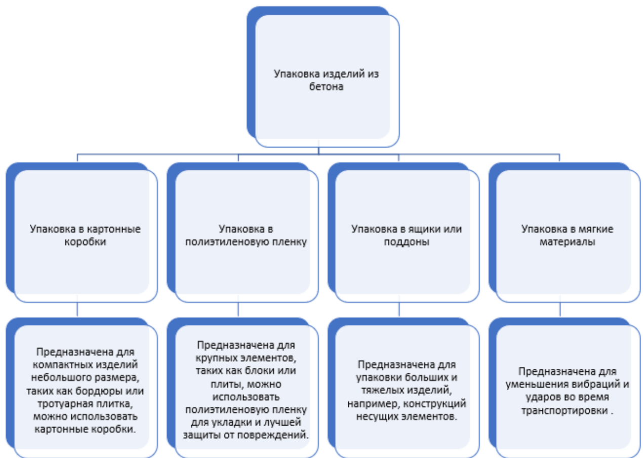
Рисунок 2.2– Упаковка изделий из бетона
