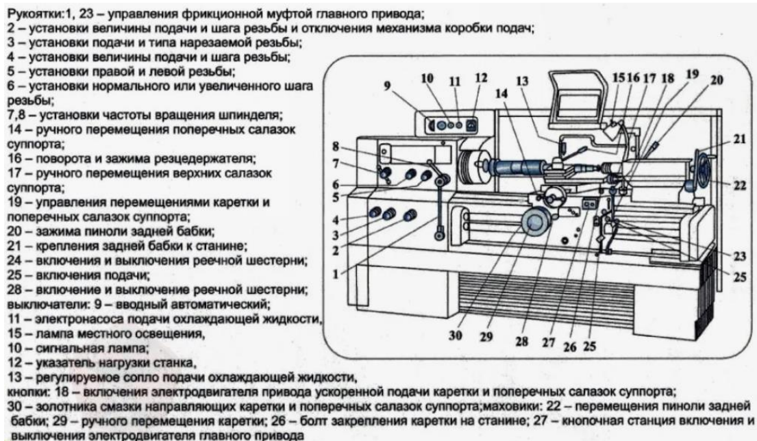
Рисунок 1 - Общий вид и органы управления станка 16К20
