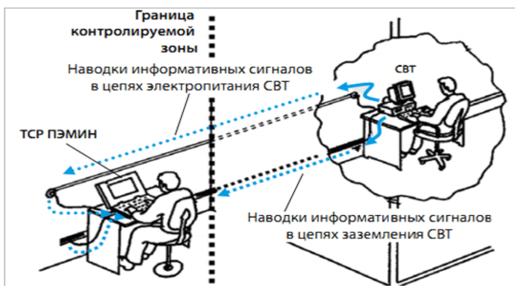
Рисунок 6 - Перехват информативных сигналов при подключении средств разведки ПЭМИН к линиям электропитания и заземления СВТ
