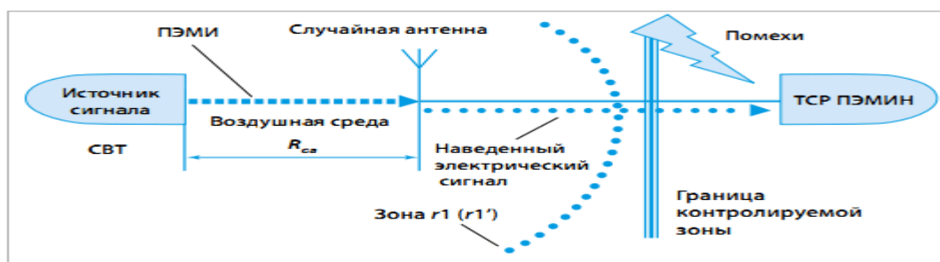
Рисунок 5 - Схема технического канала утечки информации, возникающего за счёт наводок побочных электромагнитных излучений СВТ в случайных антеннах
