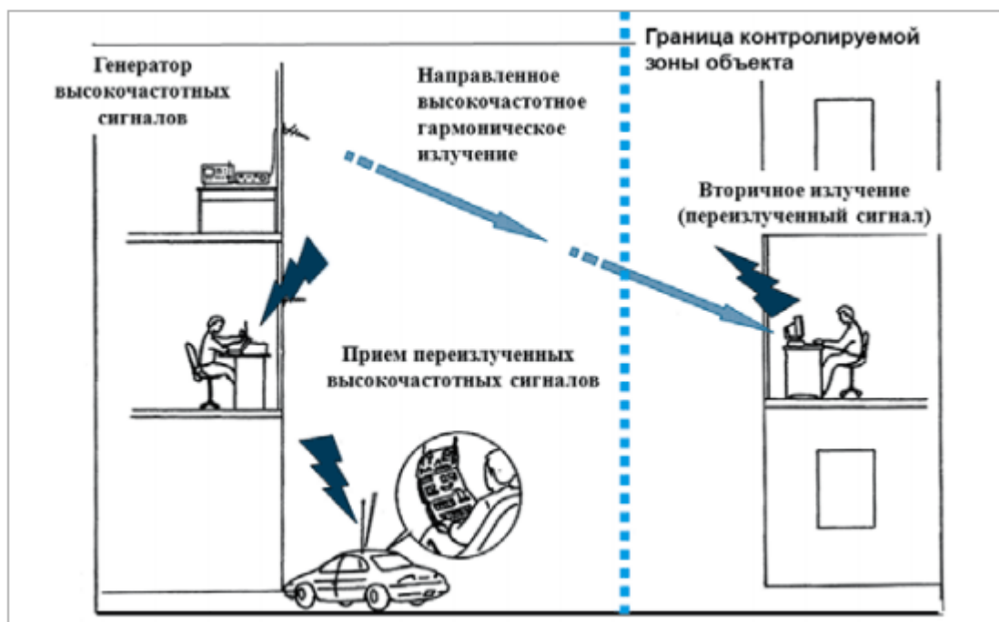
Рисунок 7 - Перехват информации, обрабатываемой СВТ, методом «высокочастотного облучения»
