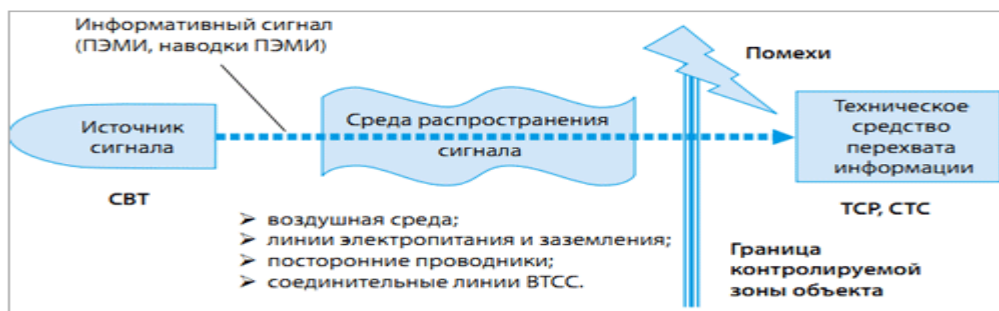
Рисунок 1 - Схема технического канала утечки информации, обрабатываемого средствами вычислительной техники
