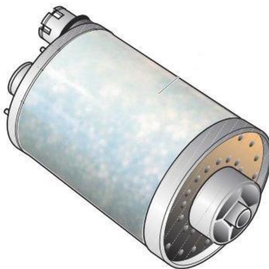
Рисунок 2.5 – Фильтр – осушитель воздуха
