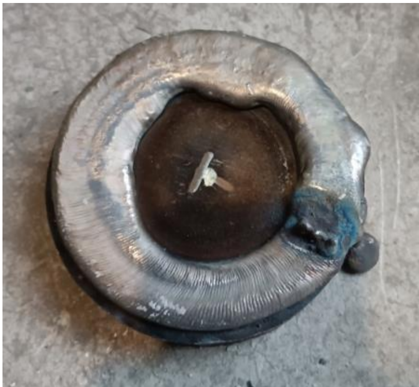
Рисунок 12 – Наплавленные образцы дисков: а) – при ручном дуговом способе; б) – при автоматическом плазменно-порошковом способе
