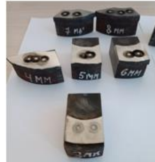
Рисунок 10 – Образцы, наплавленные ручным дуговым способом
