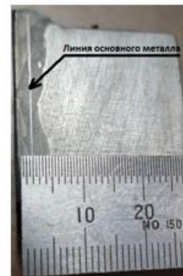
Рисунок 13 – Снимок с максимальной глубиной проплавления образца-фрагмента, наплавленного ручным дуговым способом
