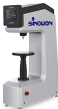
Рисунок 7 – Стационарный твердомер марки Sinowon iRock-TR1
