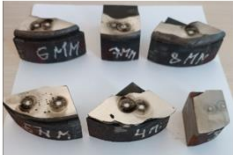
Рисунок 9 – Образцы, наплавленные автоматическим плазменно-порошковым способом
