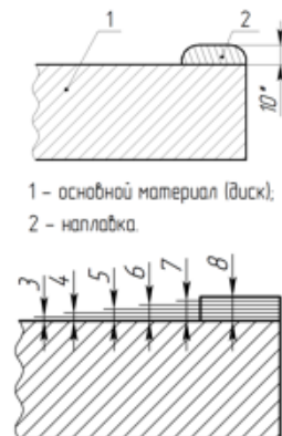
Рисунок 3 – Схема наплавки и механической обработки
