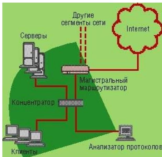
Рисунок 1.1 - Традиционная локальная сеть с разделяемой средой передачи и анализатором протоколов
