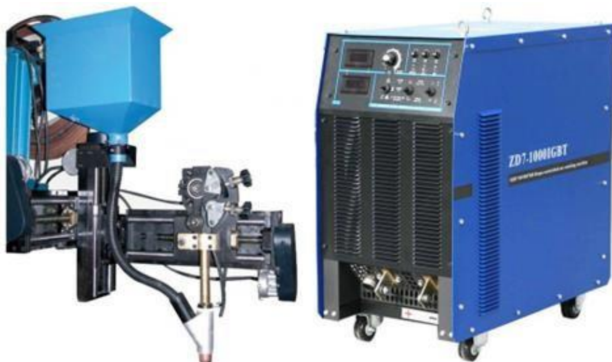
Рисунок 16 – Источник питания ZD7 и головка сварочная MZ9
