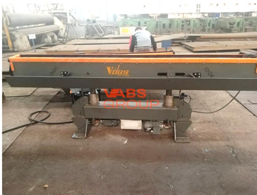
Рисунок 27 – Подушка VABS ФП–3 для сварки продольных сварных швов обечаек
