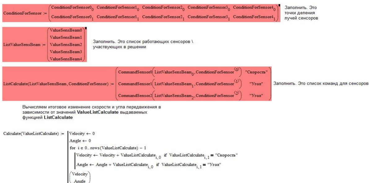
Рисунок 2.47 - Вычисление изменения скорости и угла движение
