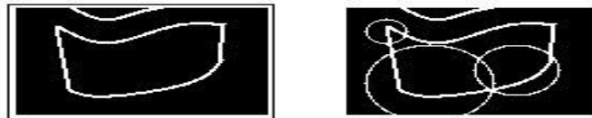
Рисунок 2.9 – Пример образования поля коллизии
