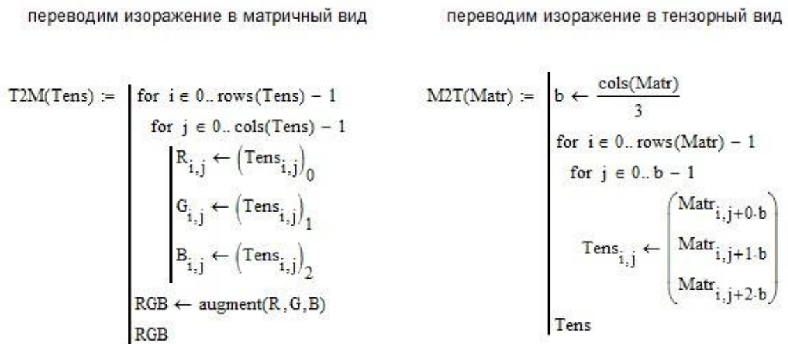
Рисунок 2.25 - Функции позволяющие переводить тензорное представление в матричное
