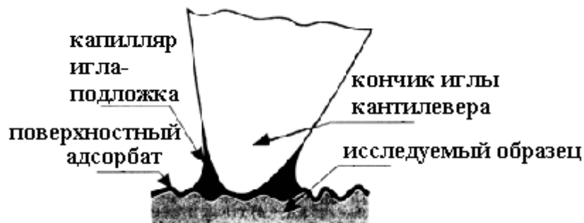
Рисунок 4 – Капиллярный эффект в контактной моде СЗМ
