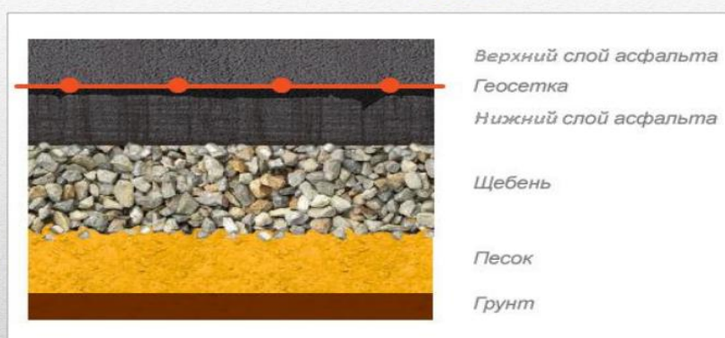
Рисунок 2.2 - Схема применения геосетки при армировании асфальтобетонных покрытий
