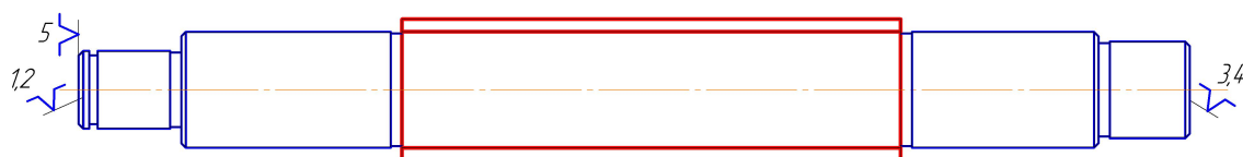
Рисунок 8 – Схема базирования на операции 025 шлицефрезерная
