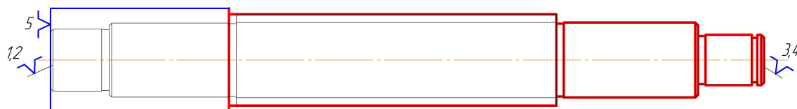
Рисунок 6 – Схема базирования на операции 015 токарная с ЧПУ
