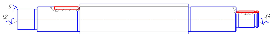
Рисунок 9 – Схема базирования на операции 030 и 035 шпоночно-фрезерная
