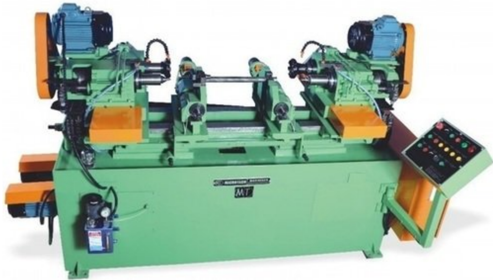
Рисунок 7 – Фрезерно-центровальный п/автомат МР-71М.
