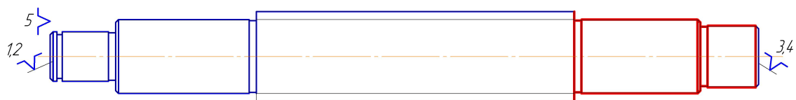
Рисунок 7 – Схема базирования на операции 020 токарная с ЧПУ
