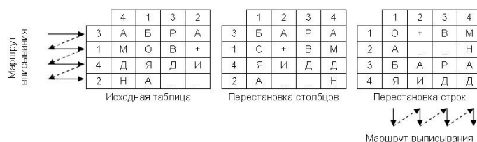
Рисунок 2 – Шифрование методом двойной перестановки
