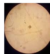
Рисунок 11 – Измерение микротвердости МДО покрытия на ПМТ -3
