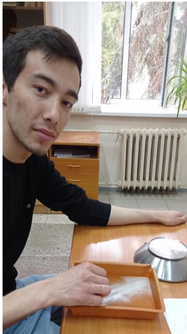
Рисунок 5 – Травление сплава АМг5 для МДО покрытий
