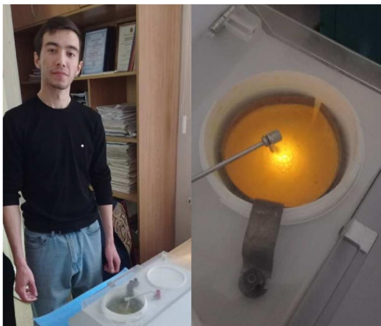
Рисунок 7 – Эксперименты по микродуговому оксидированию в выбранном электролите
