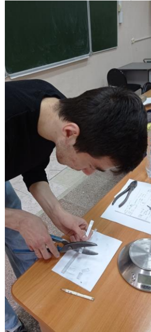
Рисунок 6 – Нарезание мерных заготовок для МДО покрытий
