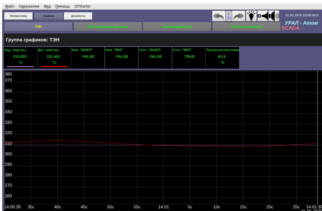
Рисунок В.6 – Установка коэффициента ПИ-регулятора, режим автоматического регулирования
