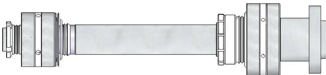
Рисунок 4.12. Общий вид компоновки шпиндельного узла
