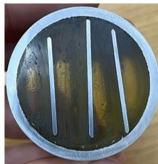
Исследование микрошлифов экспериментальных образцов КМ, полученных оксидированием
