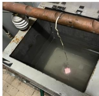
Электролитическая ванна с водяным охлаждением для эксперимента
