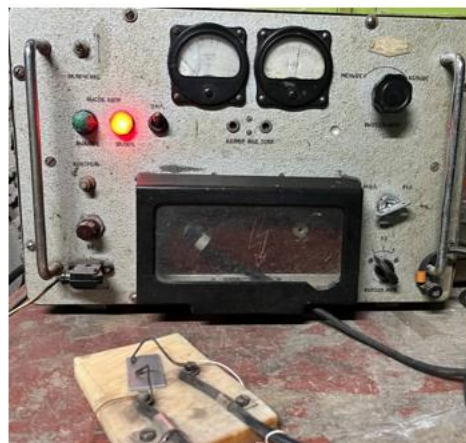
Пробойная установка УПУ-1М
