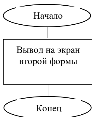
Рисунок 1 – Блок-схема обработчика события button1_click
