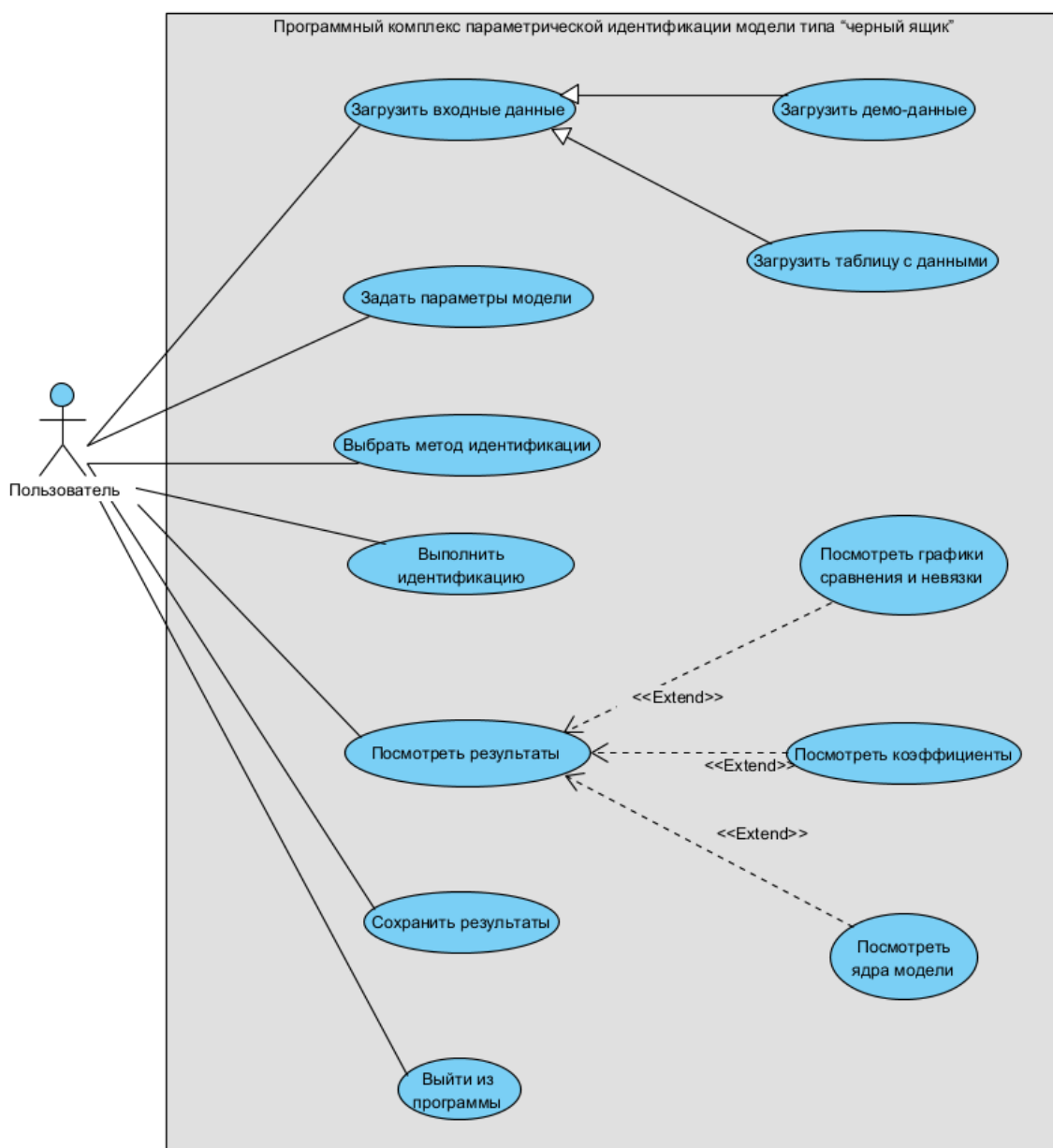
Рисунок 1 – Диаграмма вариантов использования программного комплекса
