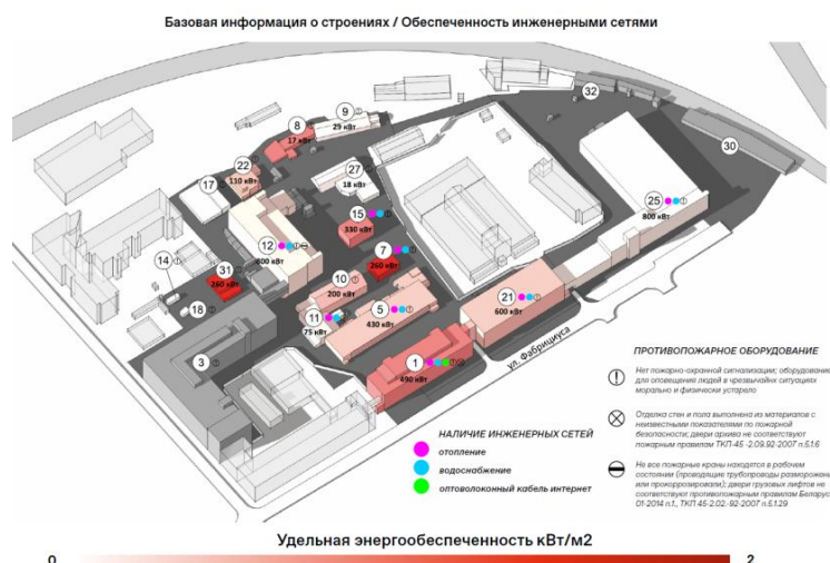
Рисунок 34 – Обзор удельной энергообеспеченности зданий на объекте
