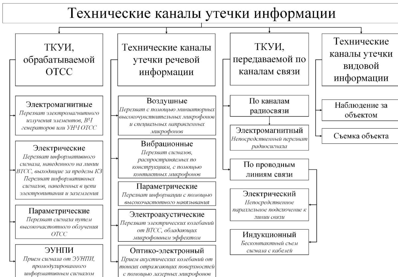
Рисунок 1 - Классификация технических каналов утечки информации
