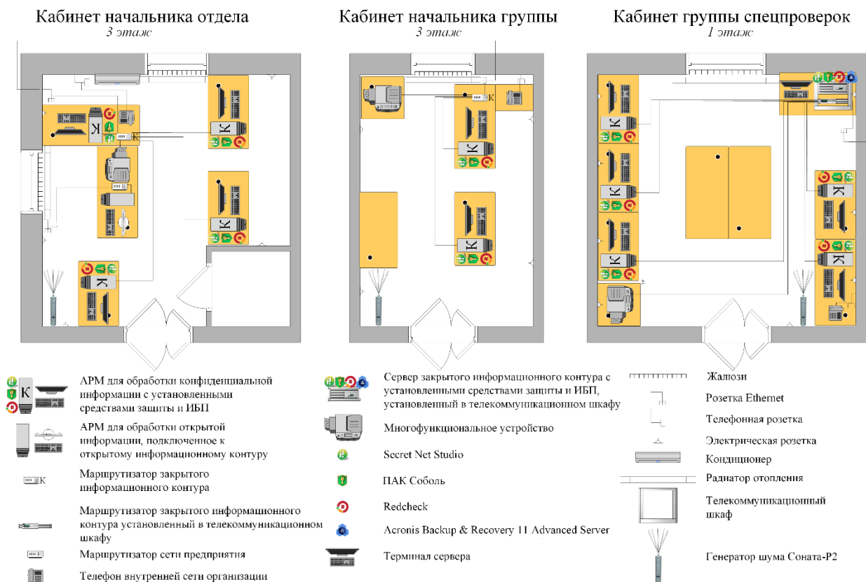
Рисунок 10 - Структура закрытого информационного контура
