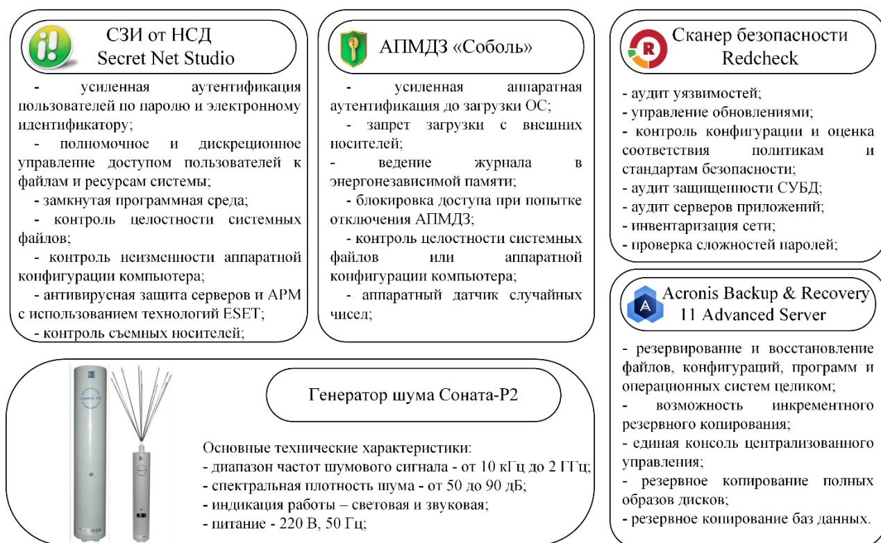
Рисунок 9 - Программно-аппаратные средства защиты информации, выбранные для закрытого информационного контура
