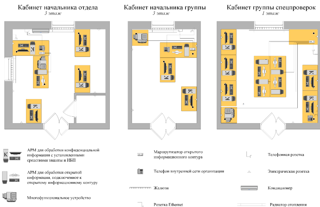
Рисунок 4 - Структура незащищенного информационного контура
