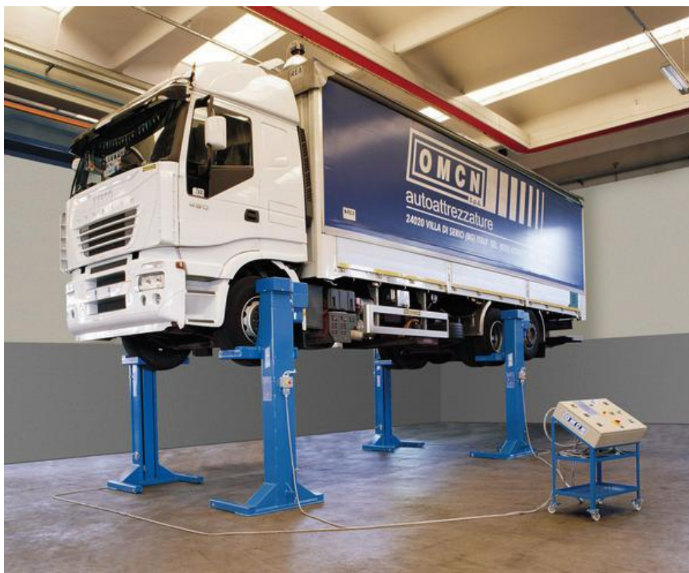
Рисунок 5.2 – Применение подъемников при ремонте грузовых автомобилей
